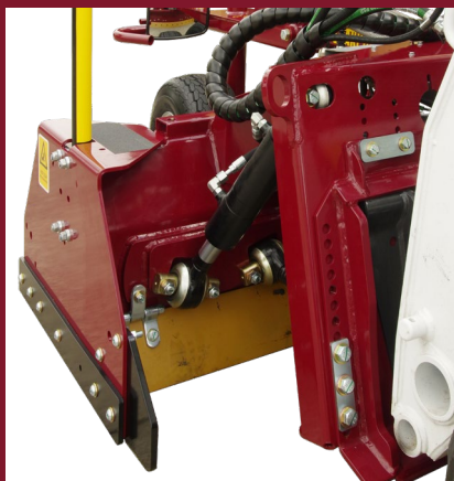
Achterblad voor precisienivellering in achteruitrijstand
