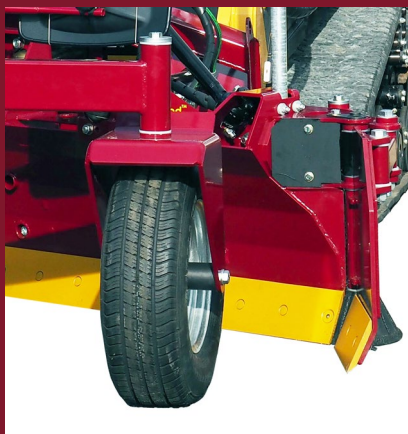
Hydraulische zijdeuren verdelen materiaal in beide richtingen
