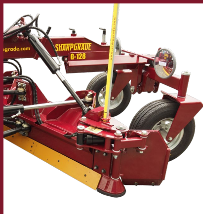
Lame arrière pour un nivellement précis en marche arrière
