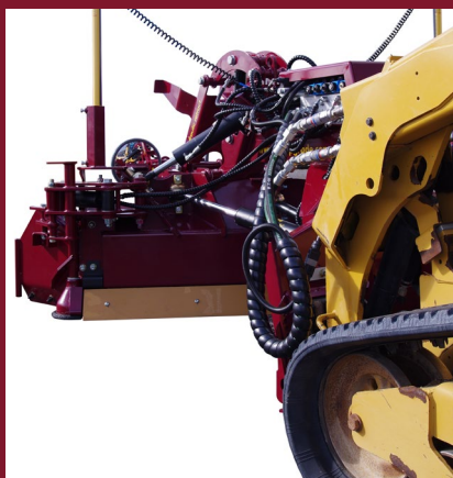
Achterblad voor nauwkeurig nivelleren in achteruit
