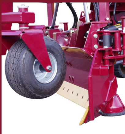
Hydraulische zijdeuren verdelen materiaal in beide richtingen
