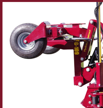
Opklapbare voorwielen voor in krappe ruimtes
