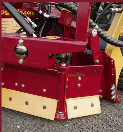
Hydraulische zijdeuren verdelen het materiaal in beide richtingen
