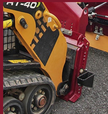
Verstelbare snelwissel plaat met geïntegreerde veiligheidsstap
