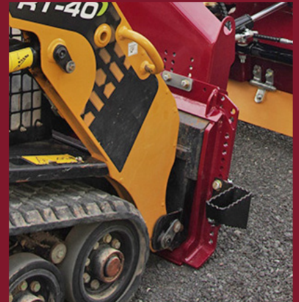
Verstellbare Anhängenplatte mit integriertem Sicherheitstritt
