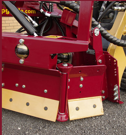
Hydraulische Seitenflügel steuern das Material in beide Richtungen
