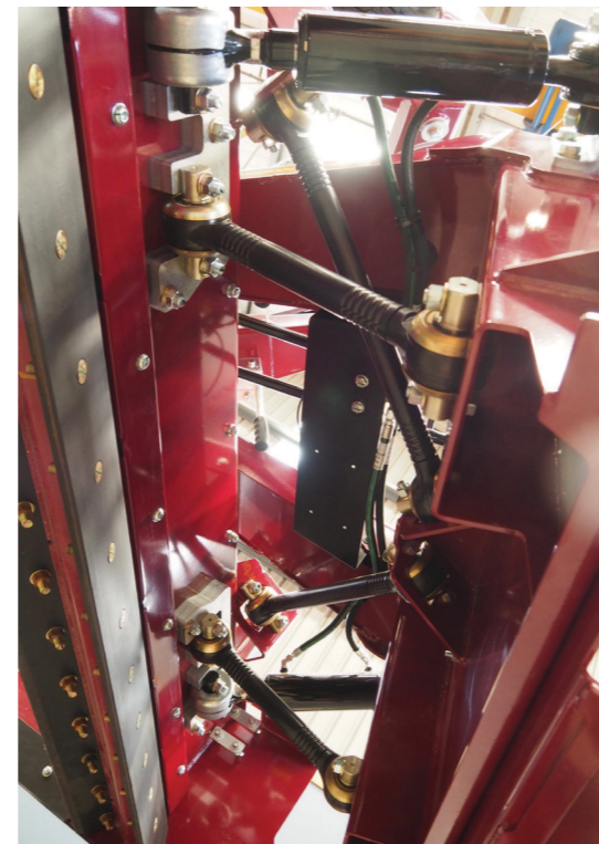
VERZEGELDE EN ONDERHOUDSVRIJE QUADROD® VERBINDING
