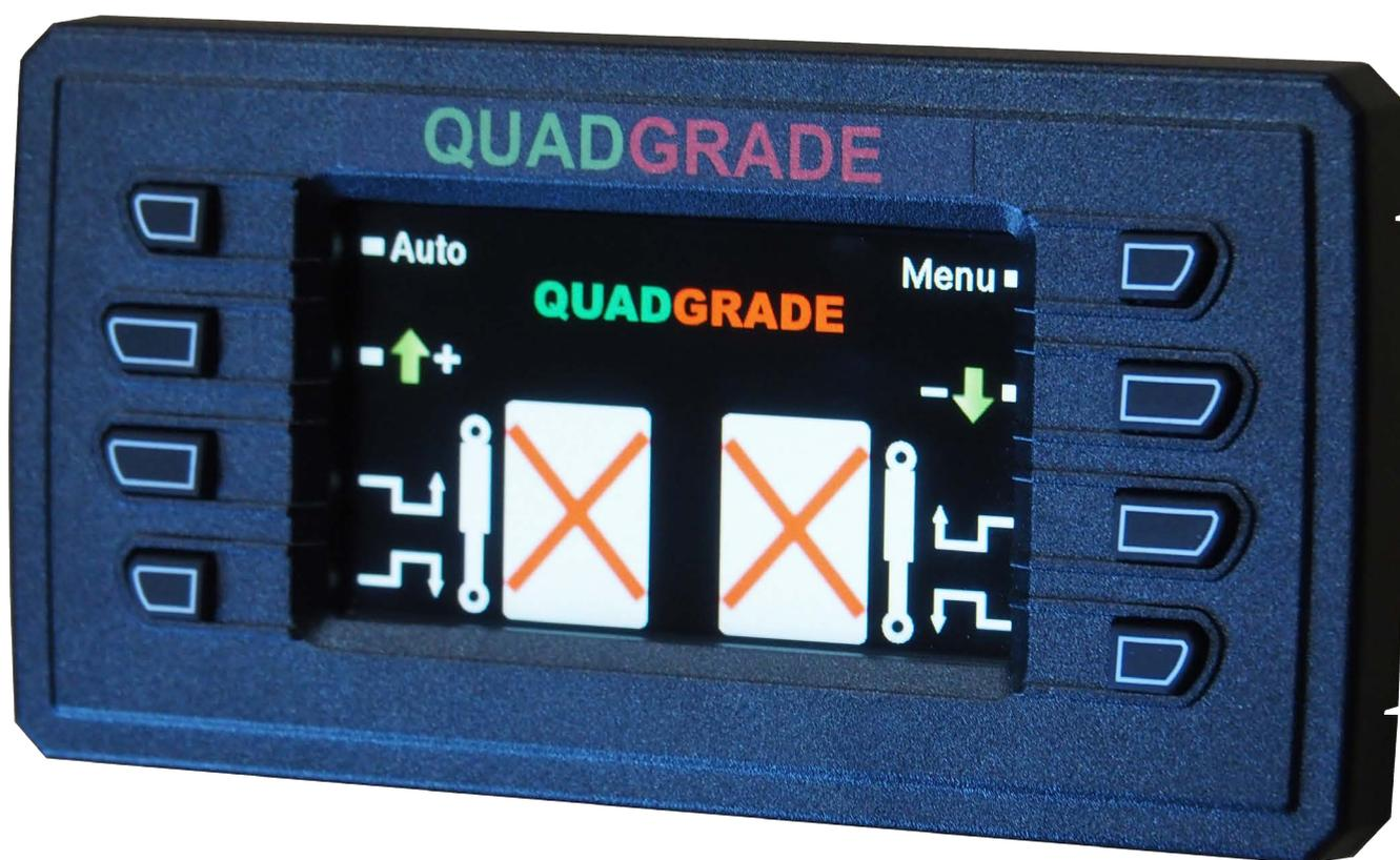
**Système de contrôle 2D étanche et compact, pour niveleuses à lame**
