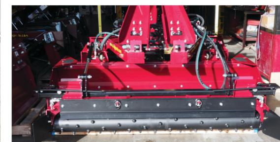
RÂTEAU DE NIVELLEMENT DE TERRAIN ATTACHE RAPIDE
